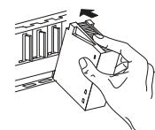
② Drücken Sie das Modul anschließend auf den Baugruppenträger, bis das Modul ganz am Baugruppenträger anliegt.
