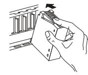
③ Ha a telepítés helyén rezgések jelentkezhetnek, rögzítse a modult rögzítőcavarokkal (M3 x 12). A cavarok nem részei a modul szállítási terjedelménynek.
