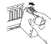
③ Asegure el módulo adicionalmente con un tornillo (M3 x 12) siempre que quiera esperar vibraciones. Este tornillo no se encuentra dentro del volumen de suministro de los módulos.
